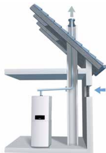
Raumluftabhängige Aufstellvariante mit eingezogenem Abgasrohr im Schornstein (nicht geeignet zur Luftansaugung)
