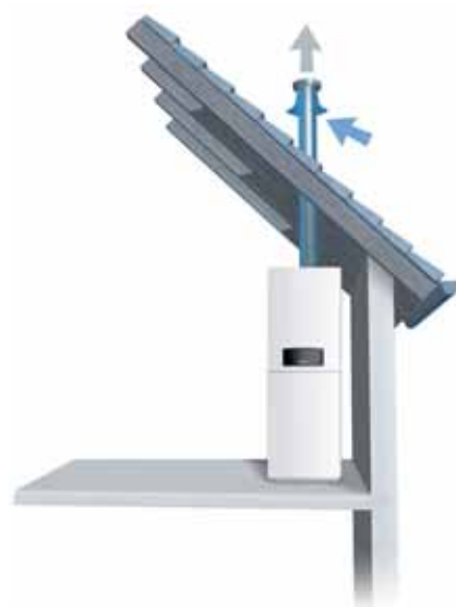
Raumluftunabhängige Aufstellvariante mit Rohr-in-Rohr-Kunststoff-Abgassystem
